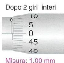
Sulla scala fissa si leggono i millimetri o i mezzi millimetri.
