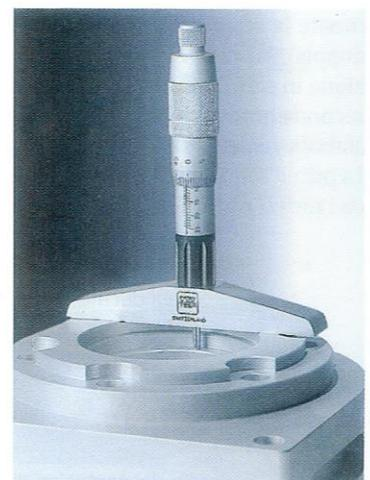
Misurazione eseguita con micrometro per profondità.
