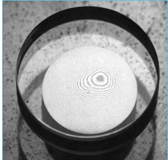
Dal numero di frange interferenziali dei blocchetti di vetro pianparalleli si può controllare la planarità e il parallelismo (FIGURA 28), perpendicolarità e rettilinearità, e il posizionamento di organi mobili, come nel caso delle macchine utensili.
