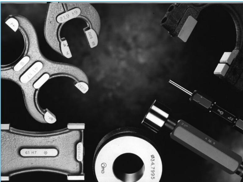
FIGURA 5. Alcuni esempi di calibri fissi.
