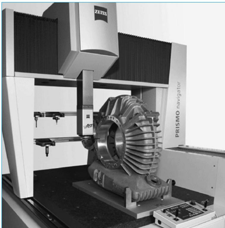
FIGURA 27. Macchina di misura a coordinate.
